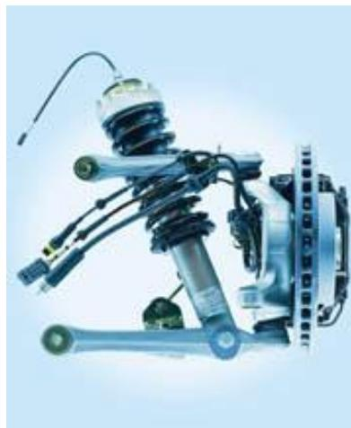
**Figura 9: Quadrilatero deformabile Maserati.**
