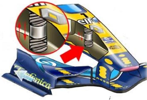
Figura 128: Sistema mass-damper sulla R26.
