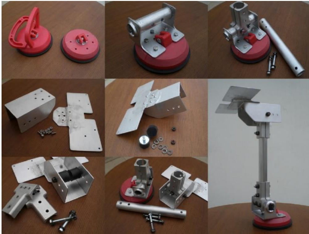
Figura 3-9 Supporto per l'installazione del sensore Kinect sulla vettura.
