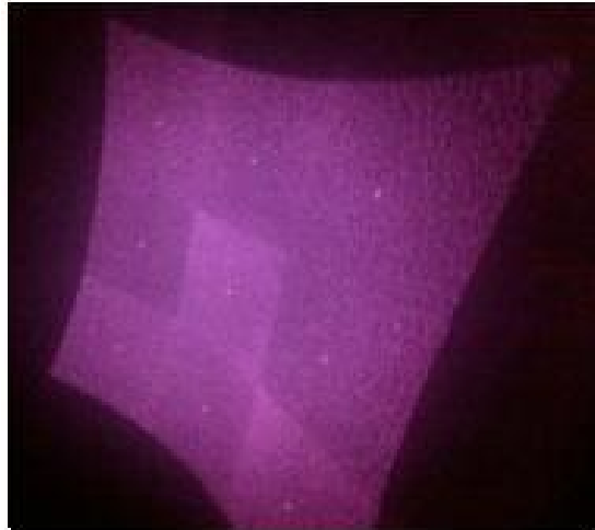
Figura 3-6 Pattern proiettato dal Kinect.
