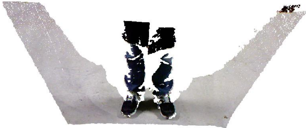
Figura 4-26 Nuvola di punti 3D relativa alla presenza di un pedone a corta distanza dal paraurti della vettura. I punti sono visualizzati con la loro codifica RGB.
