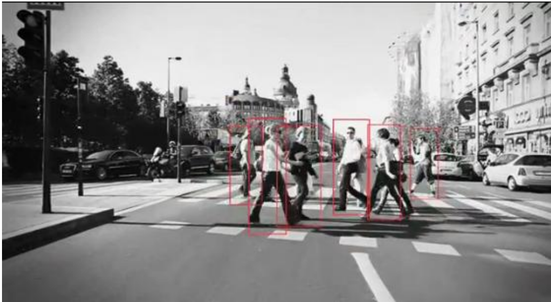
Figura 1-6 Mobileye Pedestrian Collision Warning - riconoscimento pedone [12].
