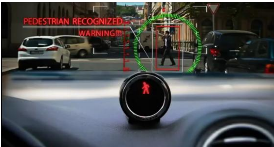
Figura 1-7 Mobileye Pedestrian Collision Warning - Segnale di allerta [12].
