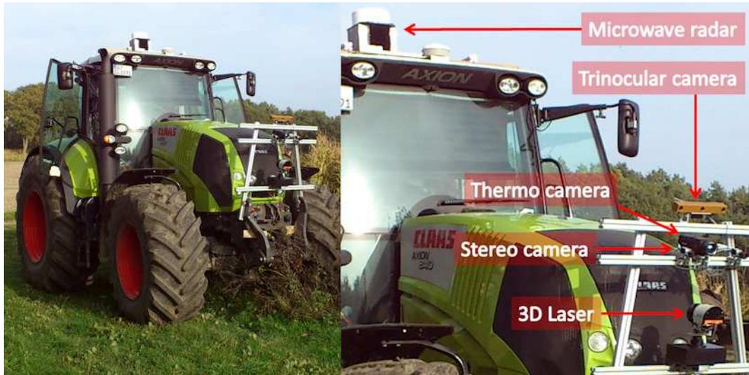
*Figura 3.4: CLAAS AXION 840 con il set di sensori di bordo.*
