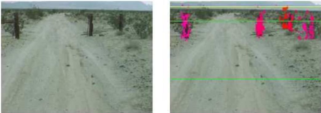
*Figura 2.3: Rilevazione di paletti piantati nel terreno.*
