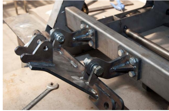
Figura 3.7 Dettaglio piastra di collegamento con l'appendice
