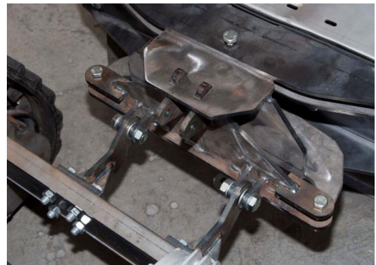
Figura 3.8 Sistema di attacco rapido locomozione-appendice
